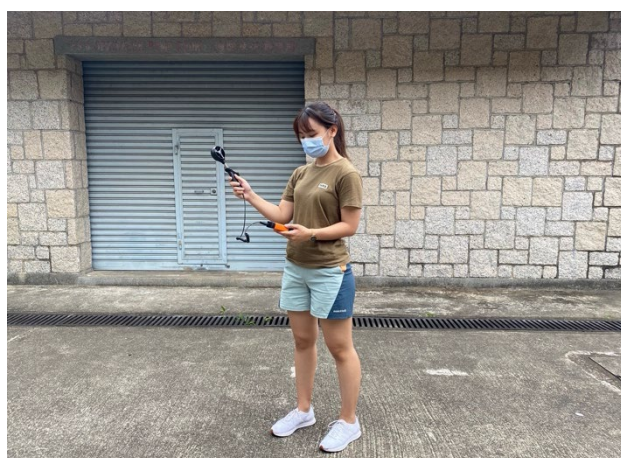
圖一. 利用光度計、風速計、電子溫度計和溫濕度計量度空地的非生物因素
