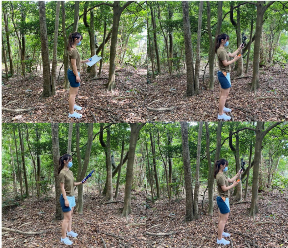
圖二. 利用光度計、風速計、電子溫度計、溫濕度計和球冠密度計量度林地內非生物因素
