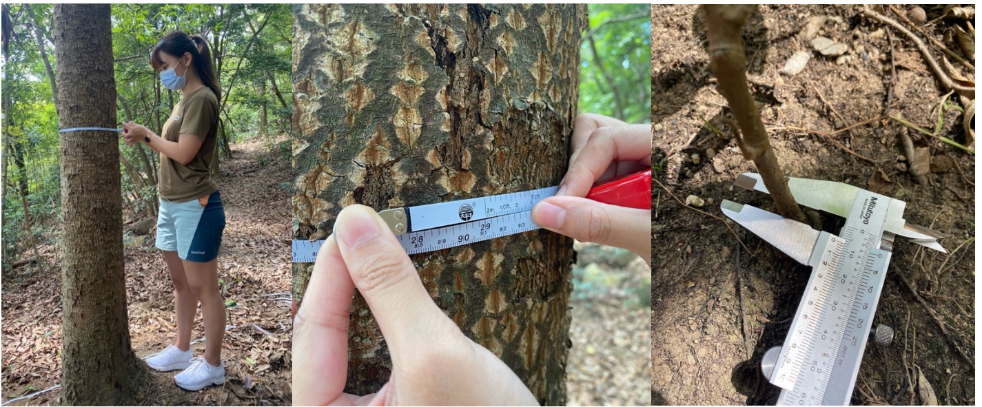
圖六. 利用捲尺（圖中）或卡尺（圖右）量度胸高直徑
