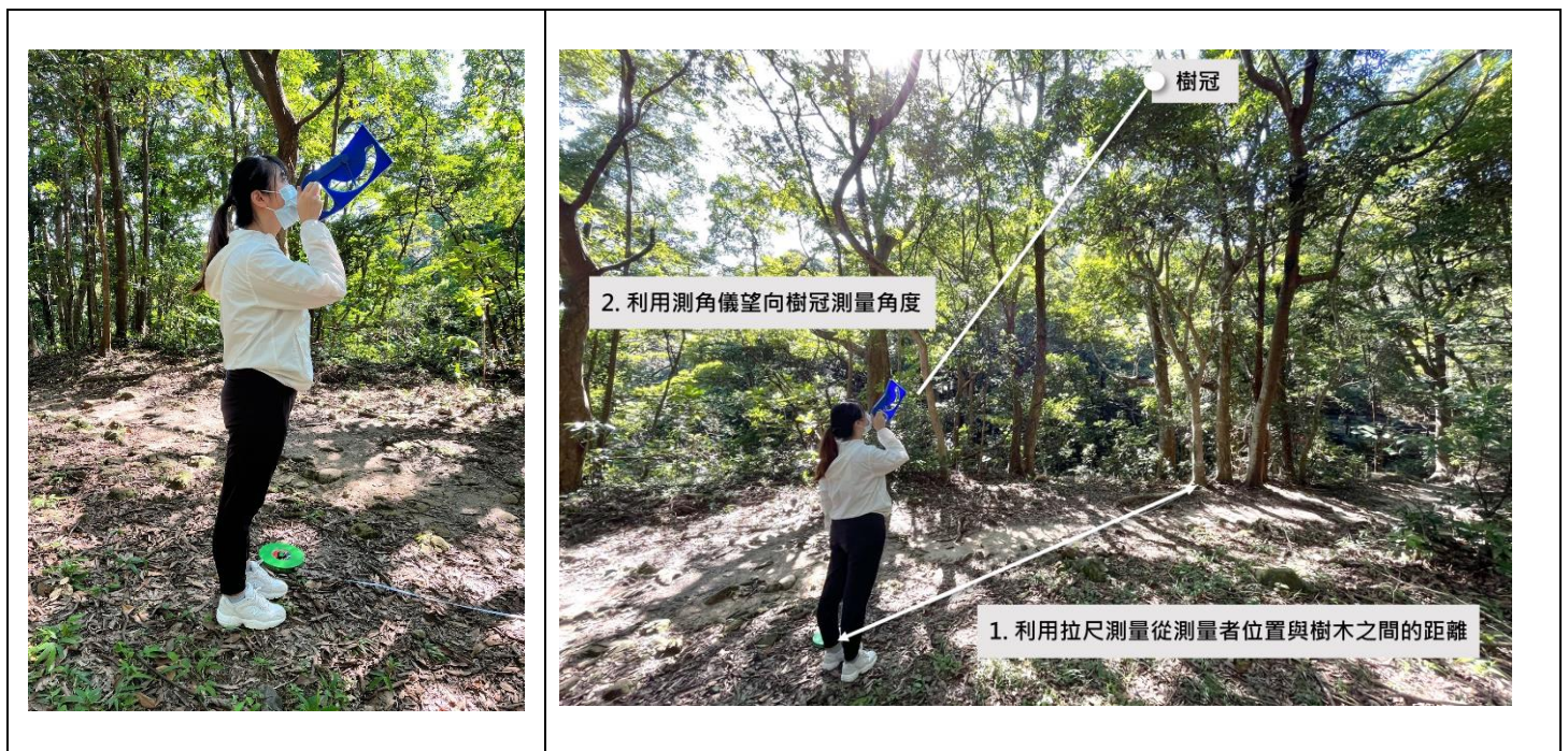
圖 6. 利用測角儀測量樹木高度
